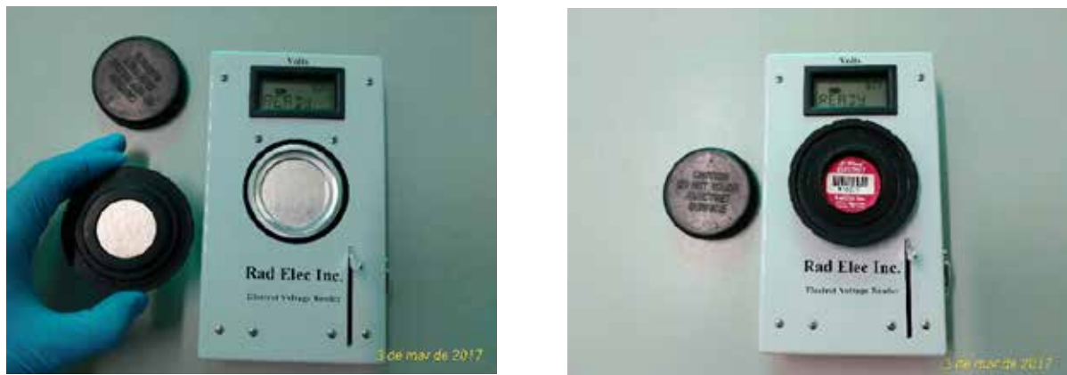
Figura 4. Sistema de detecção composto por um disco electret e voltímetro utilizado nas medições de radônio
